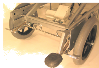
Fotbremsebøyle og pedal for vipping av vogna
